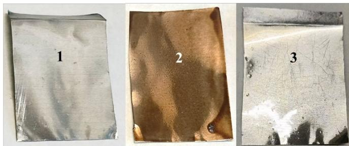
Рисунок 32 - Примеры нанесенных на алюминиевую подложку покрытий с использованием различных МС олигомеров (P и H – нанесение распылением и намазыванием соответственно)
