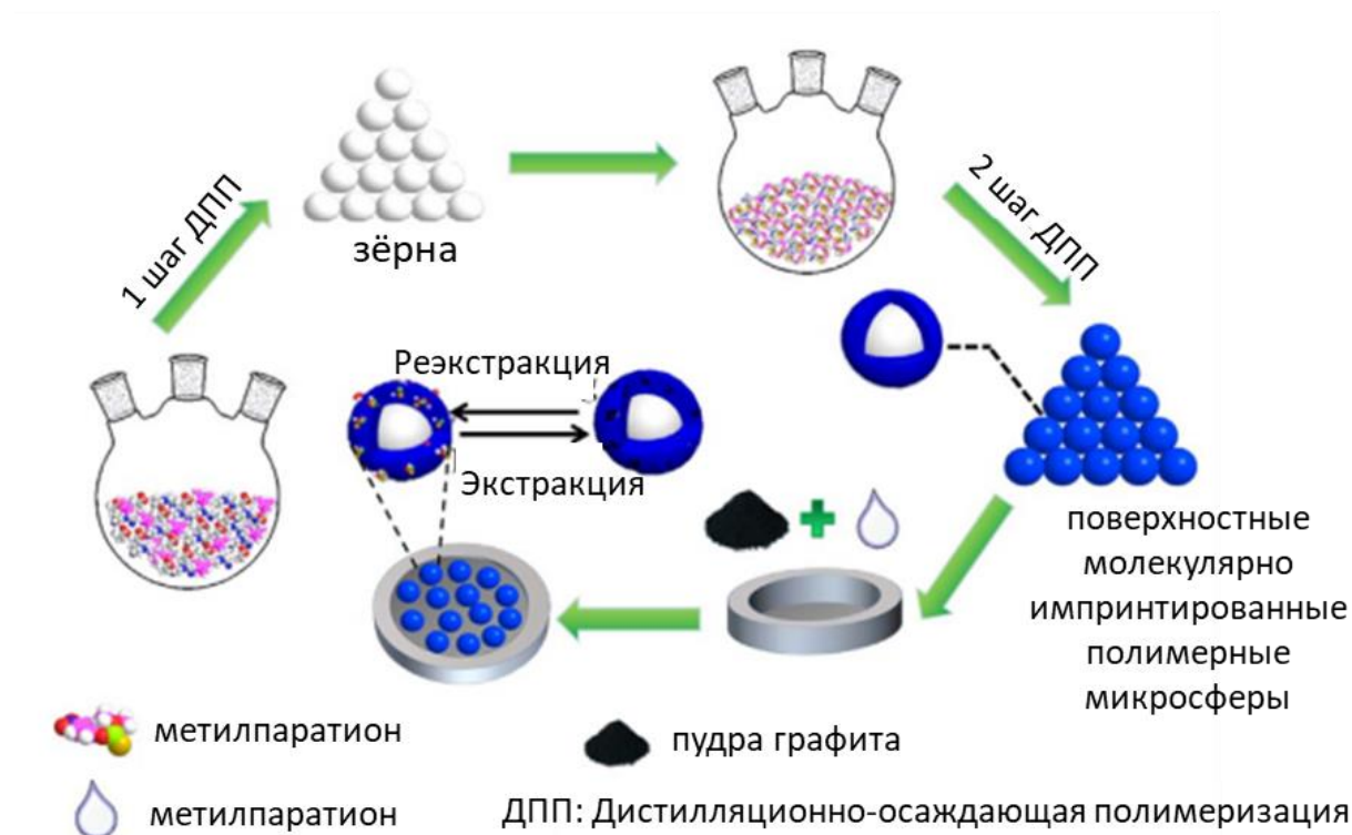
Рисунок 16 – Схема изготовления электрода из поверхностных молекулярно импринтированных полимерных микросфер и углеродной пасты
