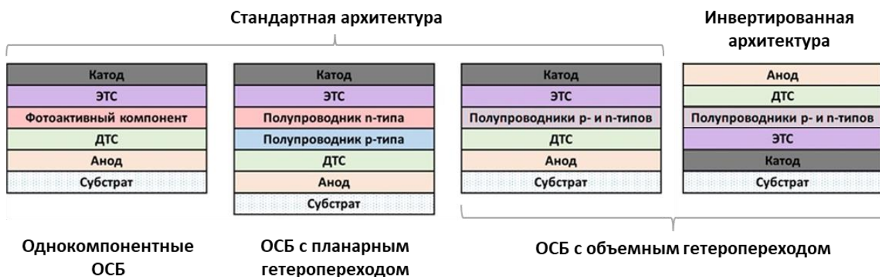
Рисунок 4 – Схематическое изображение архитектуры различных типов ОСБ, где ДТС – дырочно-транспортный слой, ЭТС – электрон-транспортный слой
