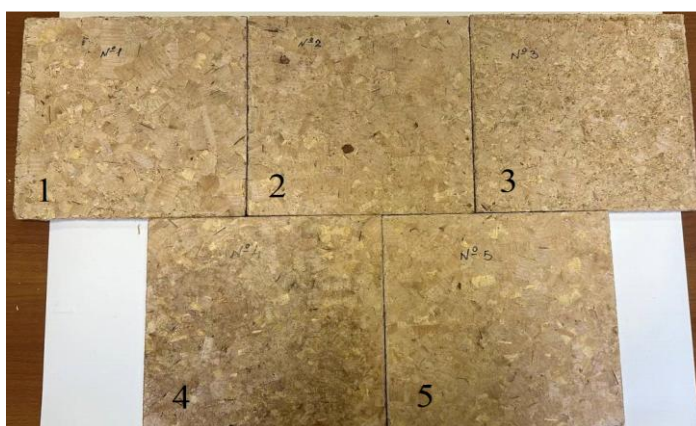
Рисунок 63 – Полученные образцы ДСП плит
