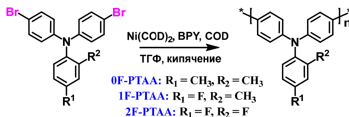
Рисунок 1.3.4 – Схема синтеза полимеров на основе ТФА методом поликонденсации по Ямамото
