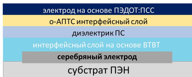
Рисунок 71 – Схематическое изображение выбранной архитектуры ППСУ с нижним и верхним проводящими электродами на основе серебра и ПЭДОТ: ПСС, соответственно.
