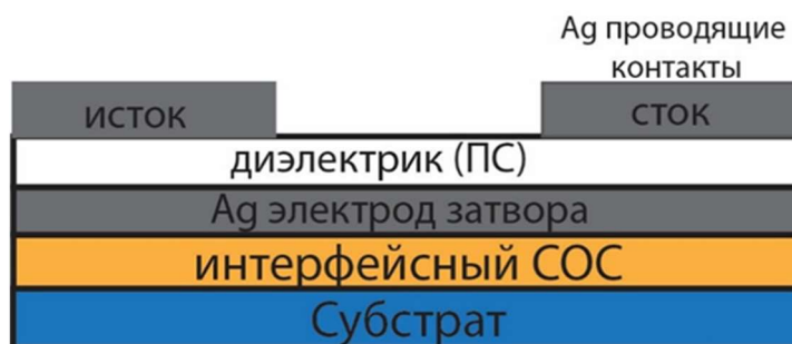
Рисунок 63 - Схематическое изображение выбранной архитектуры структурированного полимерного субстрата [131].
